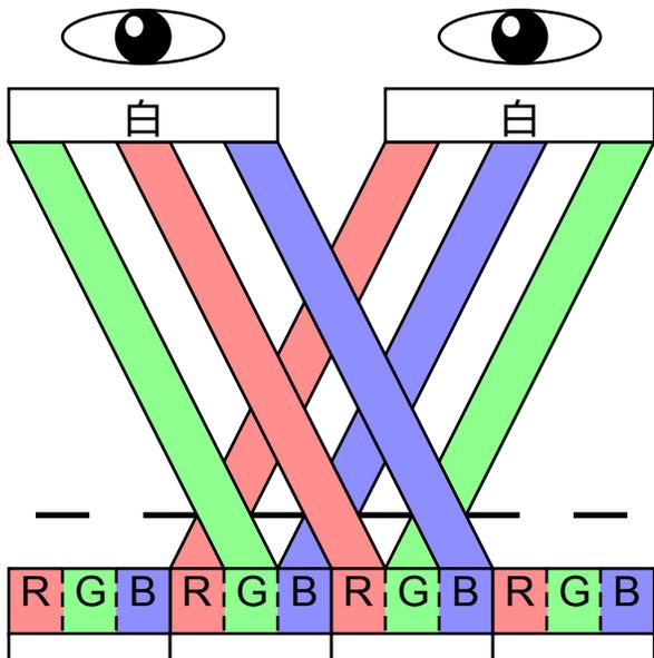
視差バリアを通すと、右目と左目に異なるサブピクセル（ピクセルの色成分）が合成されて見える。
