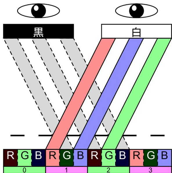
上図において左目に見せる画像を表示するとき、偶数ピクセルにその画像のG成分、奇数ピクセルにはR成分とB成分を表示する。
