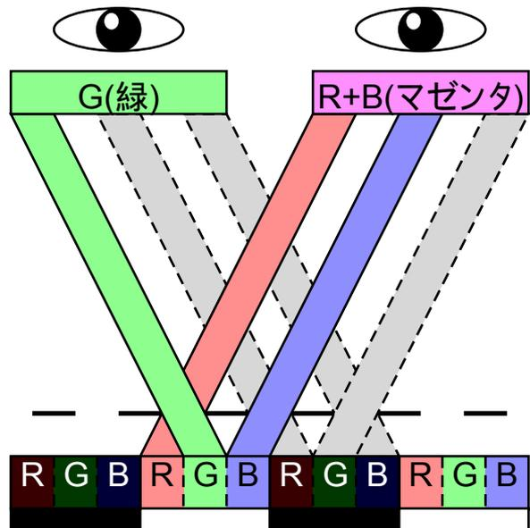
サブピクセル単位で見え隠れするので、ピクセルを交互に黒・白にすると、一方の目に緑、もう一方の目にマゼンタが見える。
