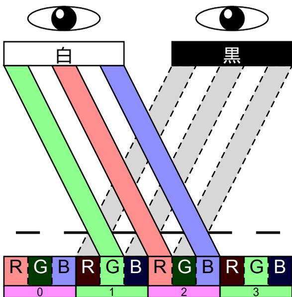
上図において右目に見せる画像を表示するとき、奇数ピクセルにその画像のG成分、偶数ピクセルにはR成分とB成分を表示する。
